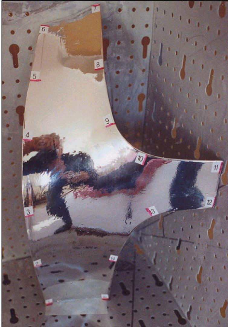
Zur Übertragung des Modells in ein 3D-Programm reichten 15 Messpunkte.
