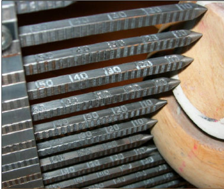
Mit einer selbst gebauten Messvorrichtung konnten die charakteristischen Kanten der Form vermessen werden.
