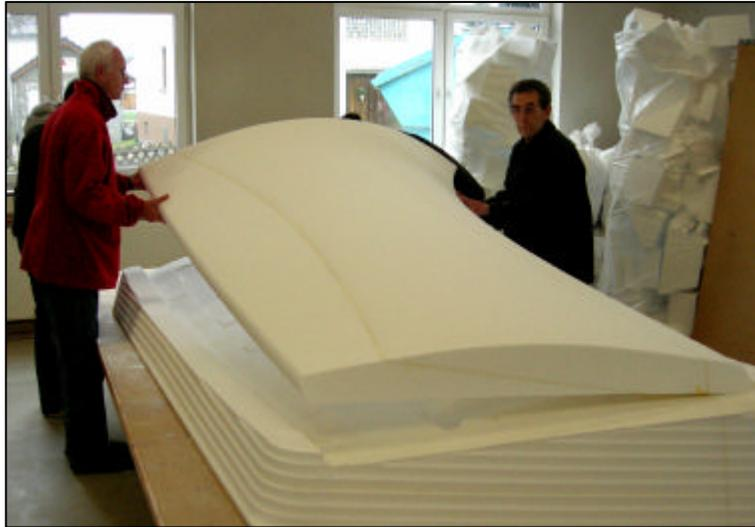
Mit einer 5-Achsen CNC-Fräse wurden die Gussmodelle aus Styropor hergestellt.
