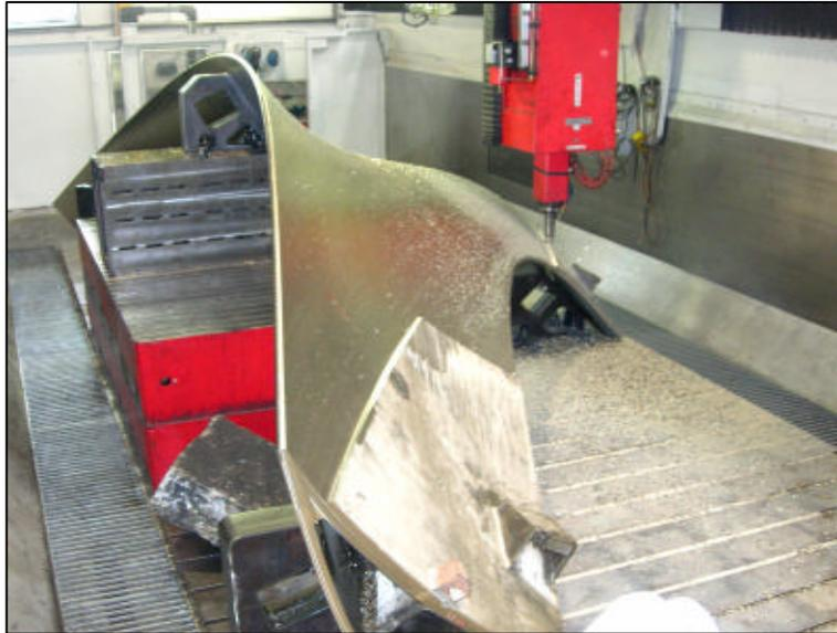
Der Rohguss wurde mit einer 5-Achsen HS-Fräsmaschine in die exakte Form gebracht.
