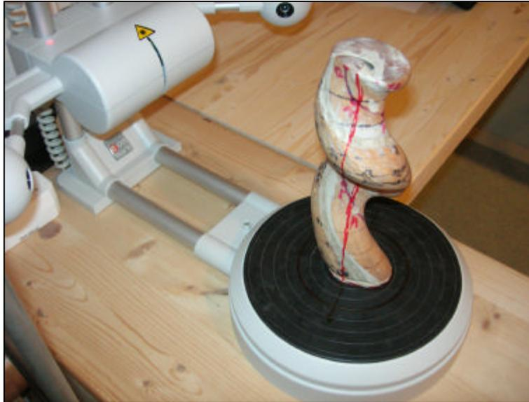
Das handgefertigte Modell wurde mit einem billigen 3D-Scanner abgetastet.
