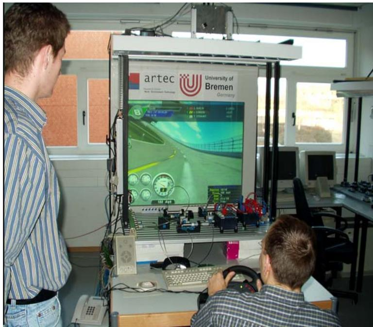
Abb. 19: Mock-Up: reales Feder-Dämpfer-System auf dem Labortisch und virtueller Rennwagen
