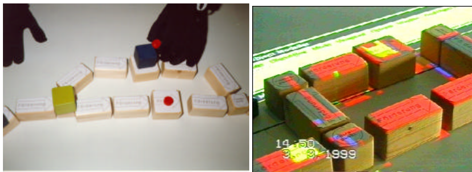
Abb.7: (links) Programmieren durch Vormachen: Erzeugen der Regel für einen alternativen Pfad. (rechts) Visuelle Erweiterung des realen Modells durch Projektion der Simulation auf die Bausteine
