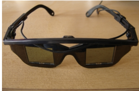
Abbildung 2.6: 3D-Shutterbrille Revelator 3D von ELSA
