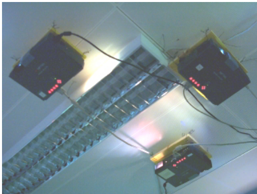
Abbildung 2.18: Beameraufhängung Abbildung 2.19: Spiegelkonstruktion Innerhalb der CAVE an der Decke Reflektieren das Bild auf die Wände
