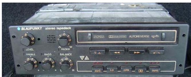
**Abbildung 7:** Das Empfängerteil mit integriertem Kassettenlaufwerk des Blaupunkt Berlin
