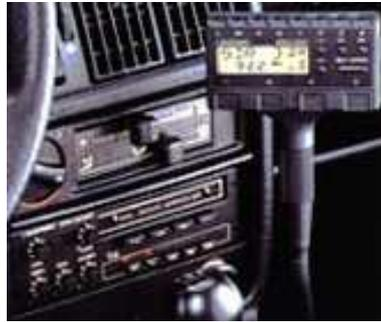
(b) Erweiterung der Funktionalität: Equalizer und Kassettenradio im Armaturenbrett, Bedienung des Radios per Bedienelement auf Schwanenhals
