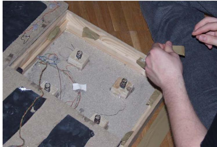
Abbildung II.73: Aufpolsterung der Puffer mit Paketband kurz vor dem Projekttag.
