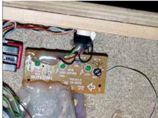
Abbildung II.22: Anbindung der Tanzmatte an den PC per Tastaturkontroller.
