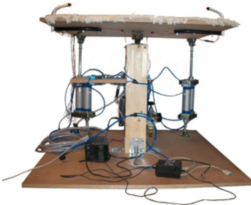
Abbildung 1.4: Finale Realisierung der Motion-Plattform
