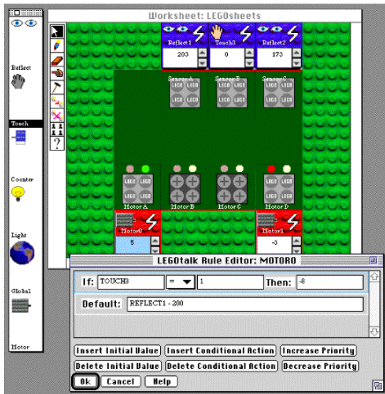
Abbildung 14: LEGOsheets zur Simulation und Programmierung des Brick.
